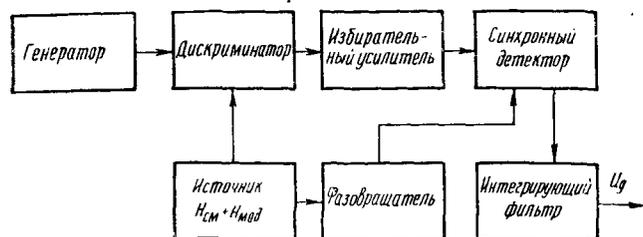
Рис. 107. Блок-схема датчика-преобразователя частоты СВЧ-сигнала в напряжение.
